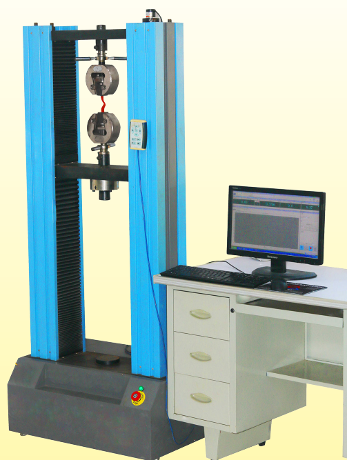
Apparecchiatura per il test di resistenza allo strappo
